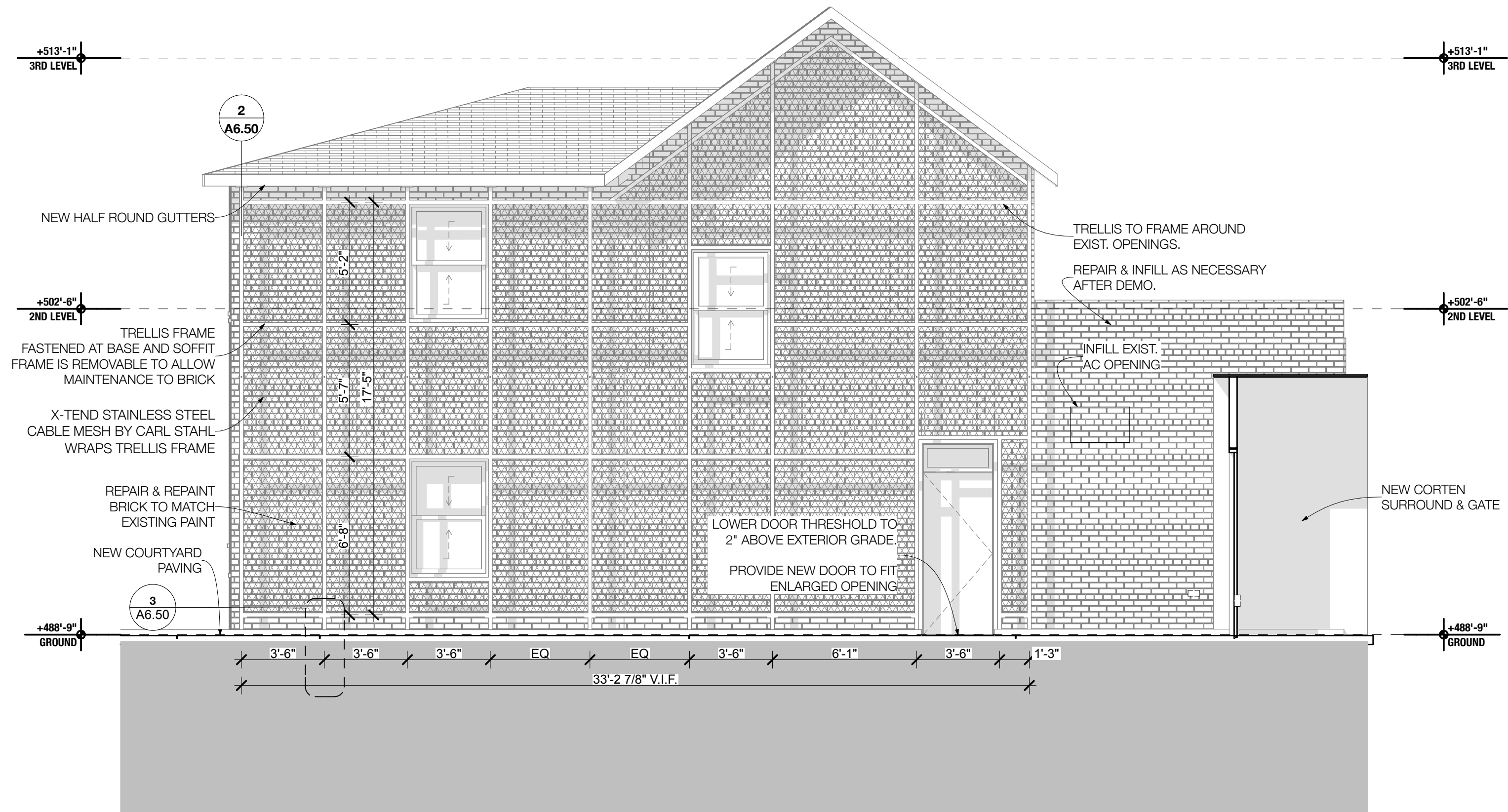
ELEVATION - EXISTING MINI MART EAST WALL 1/4" = 1'-0" 2 A2.51
